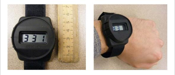
Figure 14. IM-270/PD Personnel Accident Dosimeter.
